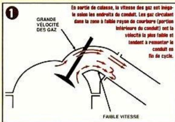
Par conséquent, en sortie de culasse lors de l'arrivée dans la tubulure d'échappement la portion des gaz dont la vitesse est la plus faible a tendance à retourner naturellement dans la chambre de combustion, voire même à remonter le conduit d'admission jusqu'au carburateur lors de la période de croisement des soupapes.
